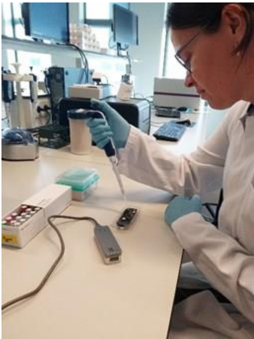
Figuur 1. Het laden van de nanopore flowcell voor een sequence run met de MinION sequencer.
